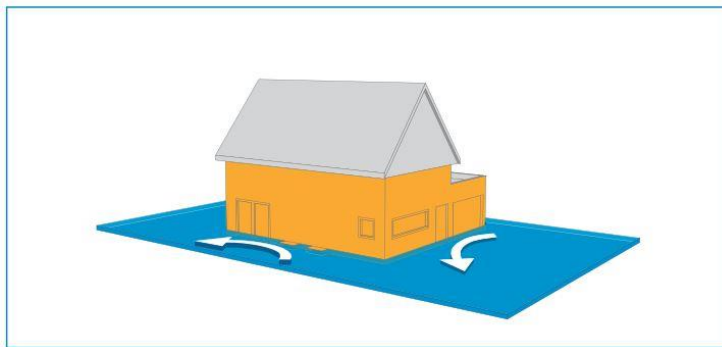
Abbildung 59: Abdichtung des Gebäudes (Stadtentwässerungsberiebe Köln, AöR, 2018, S. 16)
