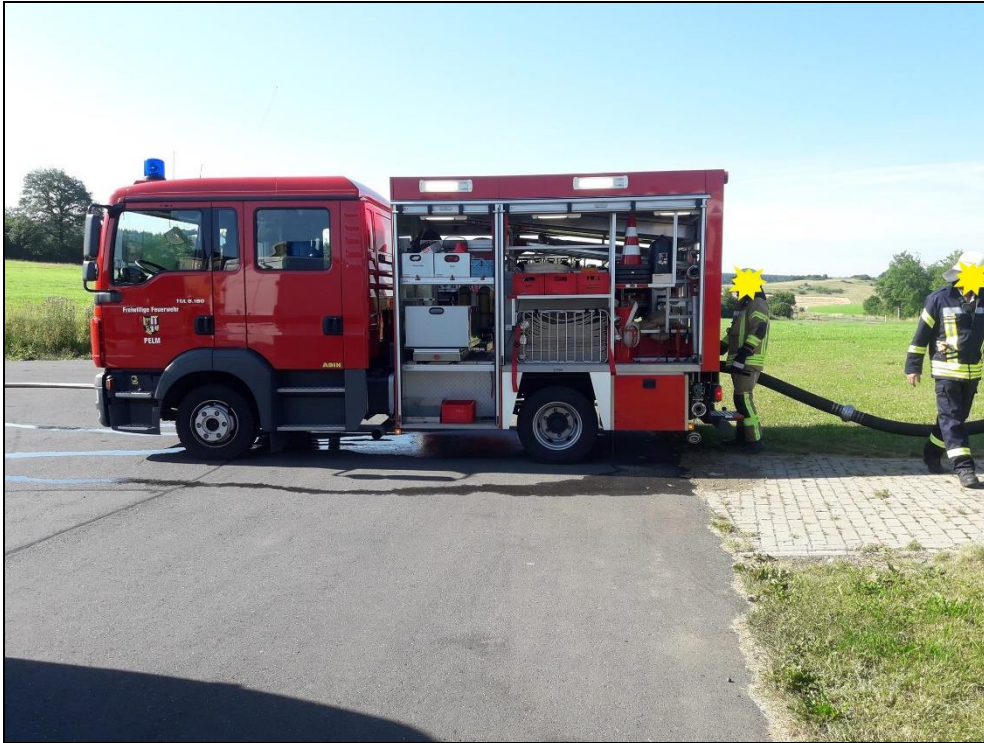
Abbildung 60: TSF FF Pelm, in etwa das gleiche Modell, wie das zukünftige Fahrzeug der FF Rockeskyll (Freiwillige Feuerwehr Pelm, 2018)
